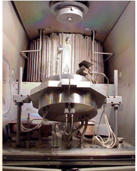
Figure 3 : Schéma de principe (à gauche) du procédé d'évaporation par canon à électrons assistée par faisceau d'ions (IAD, Ion Assisted Deposition ), et photographie (à droite) de l'intérieur d'une machine fonctionnant sur ce principe à l'Institut Fresnel-1983. Photo ©Institut Fresnel
