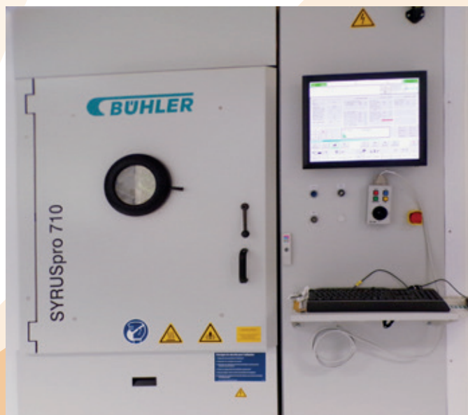
Figure 5 : procédé de dépôt par évaporation par canons à électrons assistée par plasma (SYRUSpro 710 fabriquée par la société Bühler- 2018). Photo © Institut Fresnel
