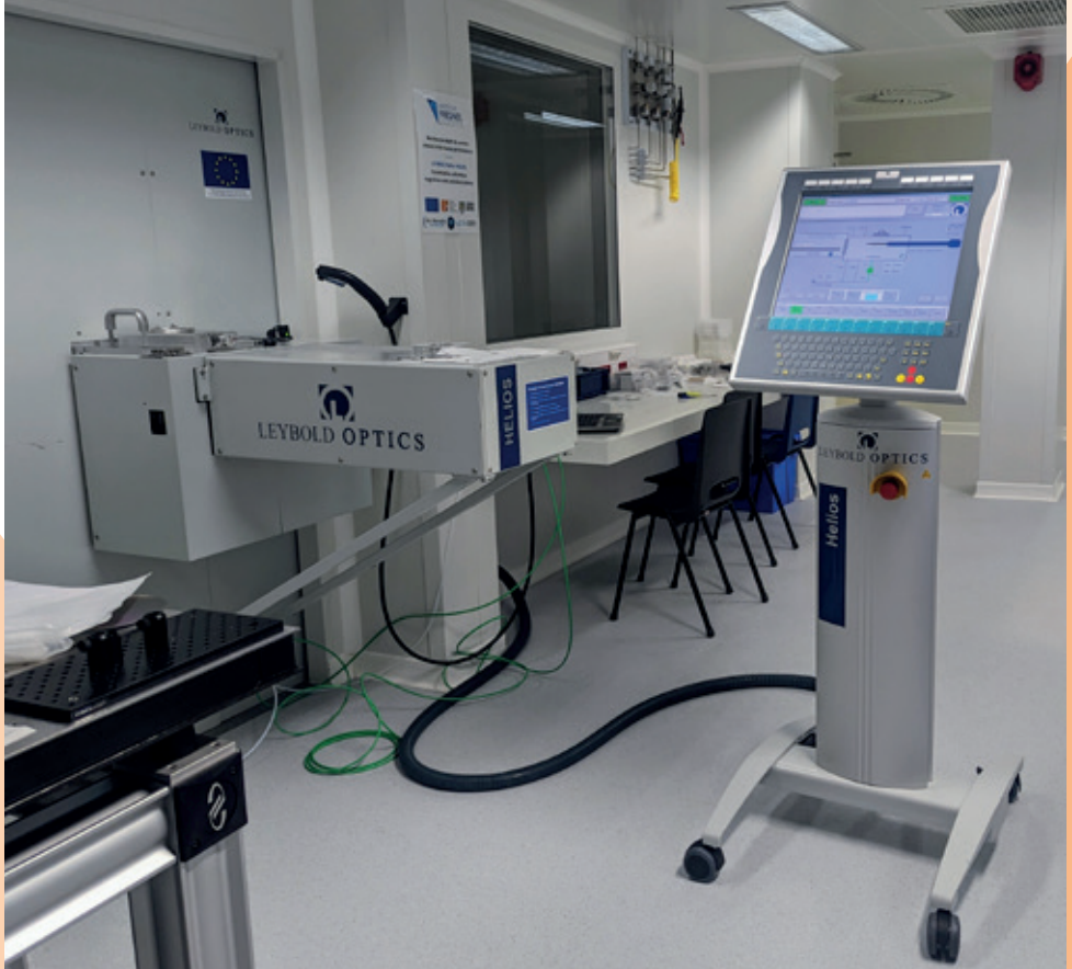
Figure 6 : procédé de dépôt par pulvérisation cathodique magnétron assistée par plasma (HELIOS 400) fabriquée par la société Bühler-2012. Photo © Institut Fresnel
