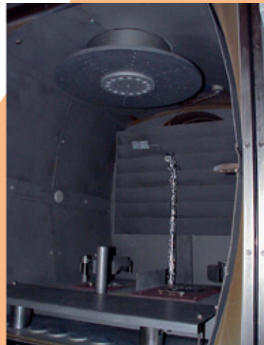
Figure 2 : Schéma de principe du procédé d'évaporation par canon à électrons (EBD, à gauche), et photographie (à droite) de l'intérieur d'une machine fonctionnant sur ce principe à l'Institut Fresnel -1980. Photo ©Institut Fresnel
