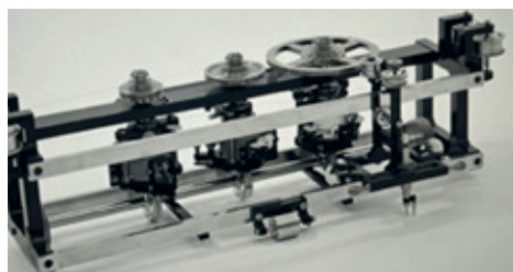
Figure 4 : Analyseur harmonique Coradi à trois intégrateurs de base 360 mm
